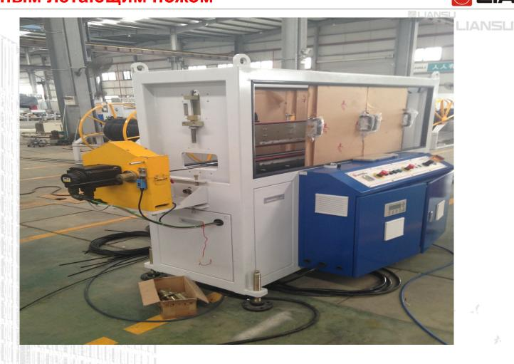
Скорость транспортировки: 1-30 м/мин, с серводвигателем 1 кВт  $\times$  2, резка ножом, мощность серводвигателя 3 кВт
